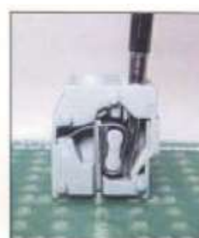
(3) Отвертка должна сохранять вертикальное положение
